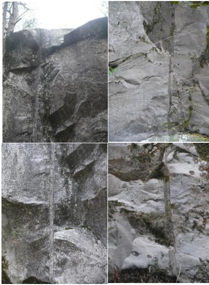
Traces de barre à mines encore présentes sur les blocs de grès, PNRGF
